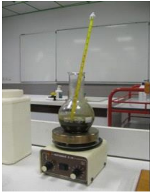
Figure 8 : Montage de l'extraction par infusion.
