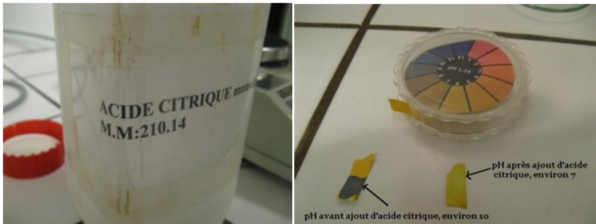
Figure 11 : papier pH pour mesurer la solution (l'extrait) avant et après l'ajoute de l'acide citrique (lycée Sud-Médoc-Gironde-France, 2010).
