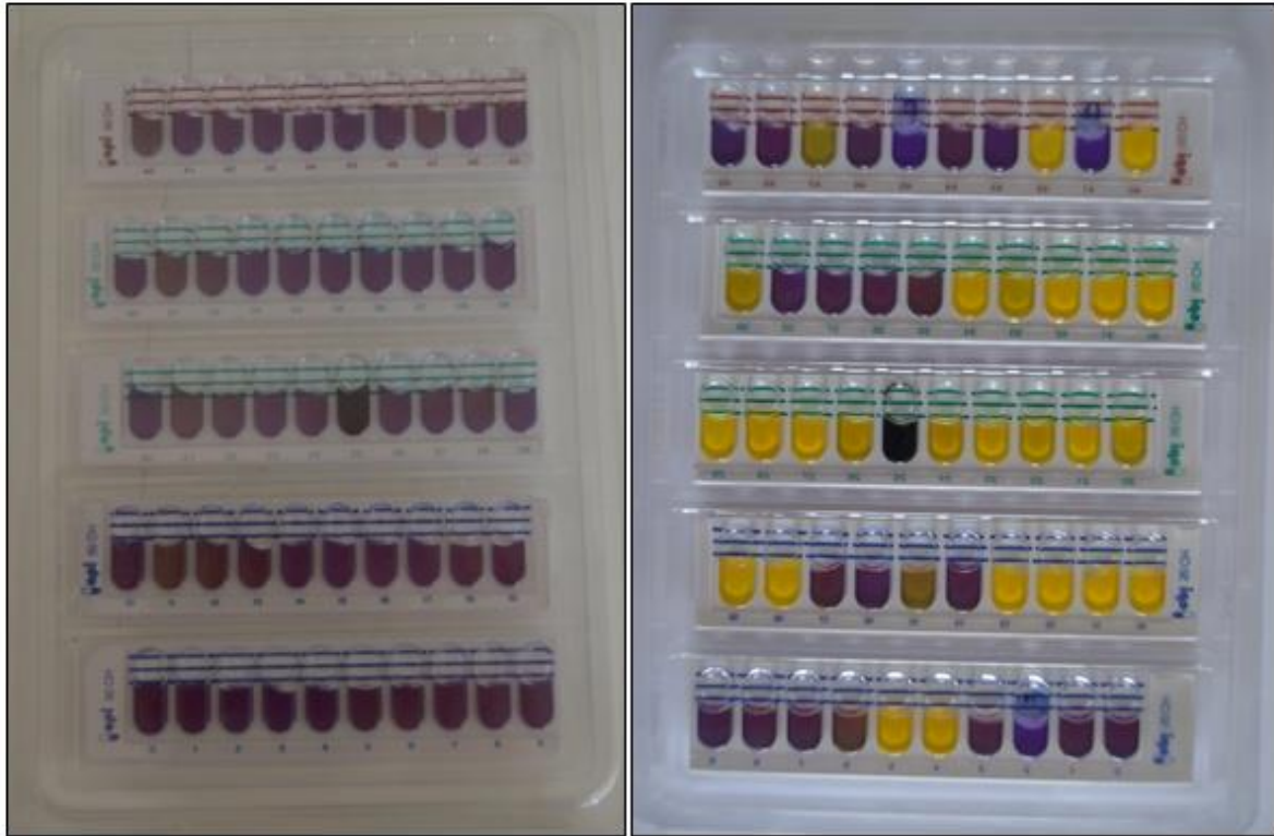
Figure 10. Exemple du profil fermentaire (galerie Api 50 CH ) des bactéries lactiques (avant et après incubation).
